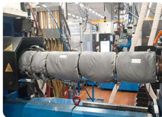
Manchons isolants sur une presse à injecter Texen CMSI
